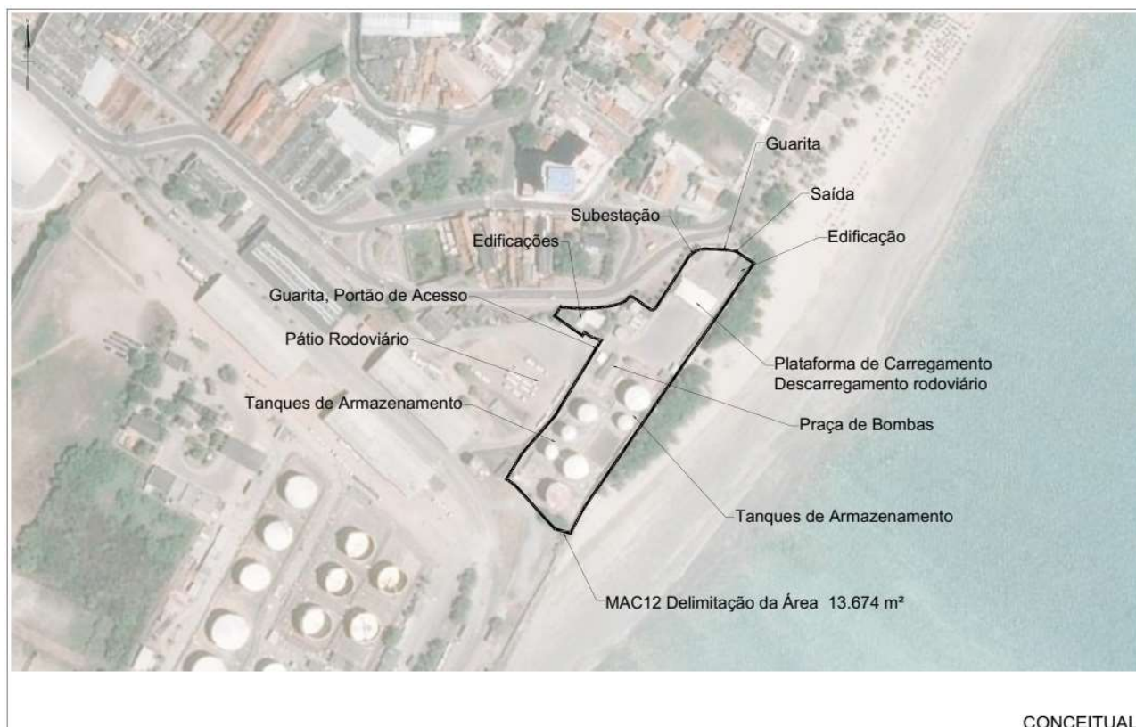
Figura 1: Layout geral da área de arrendamento MAC12 – Porto de Maceió. Fonte: Elaboração Própria (Seção C).
